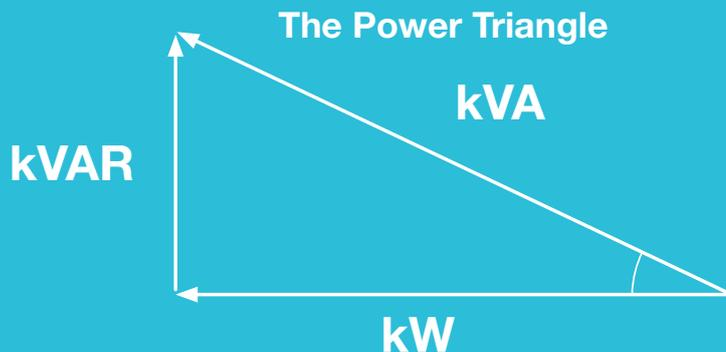
$$\text{Power Factor (PF)} = \frac{\text{kW}}{\text{kVA}}$$
